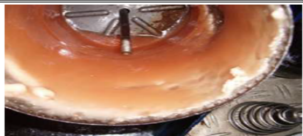
그림 3. 왁스 성분의 고체화 현상에 의한 연료필터 폐색 사례
